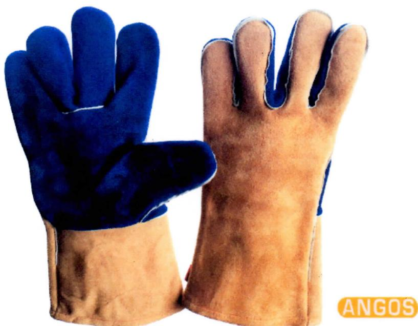
Elaborado en cuero semi gamuzón de 1.6 a 1.8 mm de espesor, flexible y resistente. Refuerzos en las costuras, forro interior con tela fleece. Destinado para trabajos de soldadura eléctrica.
